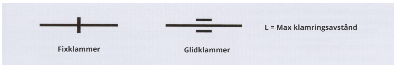
Figur 4. Symboler för klammertyper
